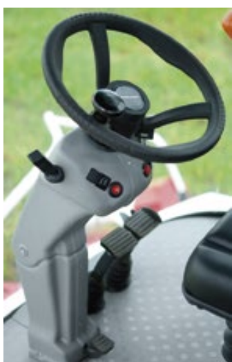
Регулируемая рулевая колонка и водительское кресло легко подстраиваются под анатомические особенности водителя.
