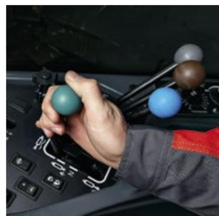
**Рычаги управления** удобно расположены на боковой консоли, что упрощает эксплуатацию и обслуживание трактора RSM. Под каждым из рычагов имеется трехпозиционный фиксатор, что позволяет легко выбрать и зафиксировать нужную для работы настройку.
