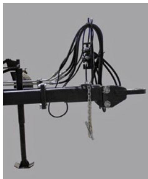
**На дышле культиватора предусмотрено удобное хранение гидравлических шлангов и электропроводки. Гидравлика надежна и не требует особого обслуживания**
