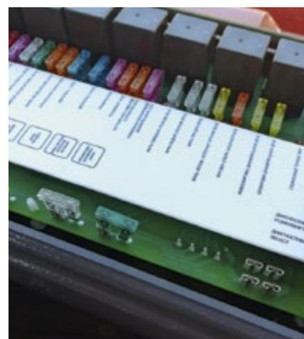
**Электронная панель**, удобно расположенная в кабине за сиденьем оператора, имеет четкое обозначение предохранителей, что позволяет производить обслуживание во время работы трактора, не отвлекая оператора от работы.
