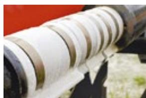
Удобная настройка глубины обработки через сегменты на шток цилиндров.
