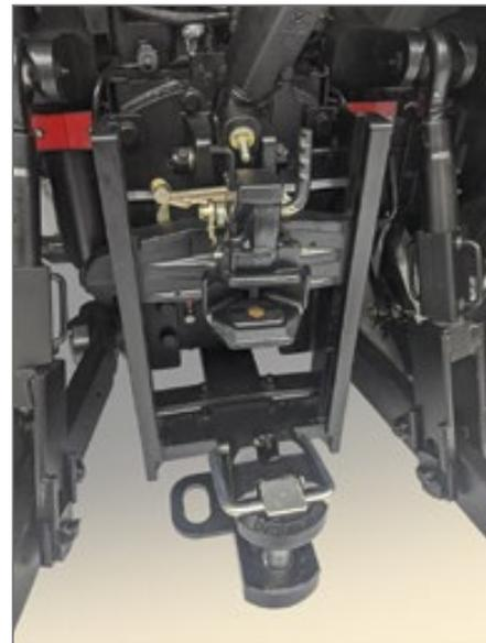
**Опциональное тягово-сцепное устройство лифтового типа** с различными фаркопами (палец, «шар», «питон») и одно- и двухконтурные пневматические тормоза прицепа делают максимально удобным перемещение различных прицепов.
