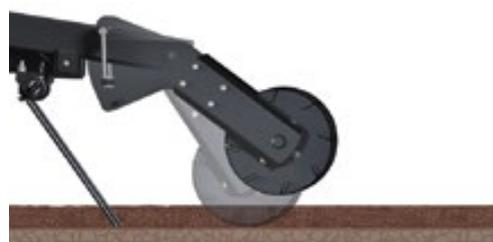
**Каток** не имеет центрального вала, что облегчает его работу по влажной почве и большому количеству пожнивных и растительных остатков без забивания или наматывания.
