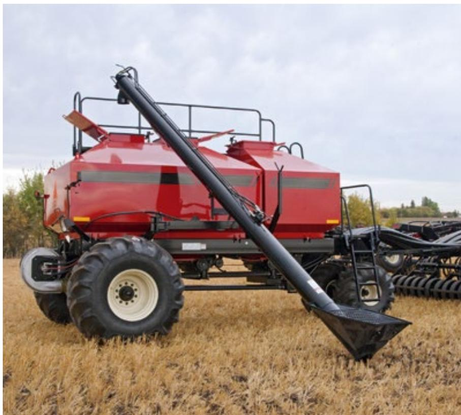
Стандартный для всех моделей бункеров загрузочный шнек диаметром 213 мм обеспечивает быструю загрузку семян и удобрений в резервуары, а удачная конструкция воронки позволяет наиболее комфортно загружать семена без разбрасывания их по сторонам при вращении шнека.
