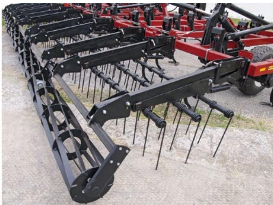
**Комбинированный шлейф культиватора**, состоящий из трехрядных пружинных борон и катка с активными планками, производит выравнивание поверхности поля. Пружинный механизм догрузки (от 40 до 80 кг) и возможность изменения углов установки пружинных зубьев особенно эффективны при вычёсывании и выносе на поверхность поля корневой системы сорной растительности.
