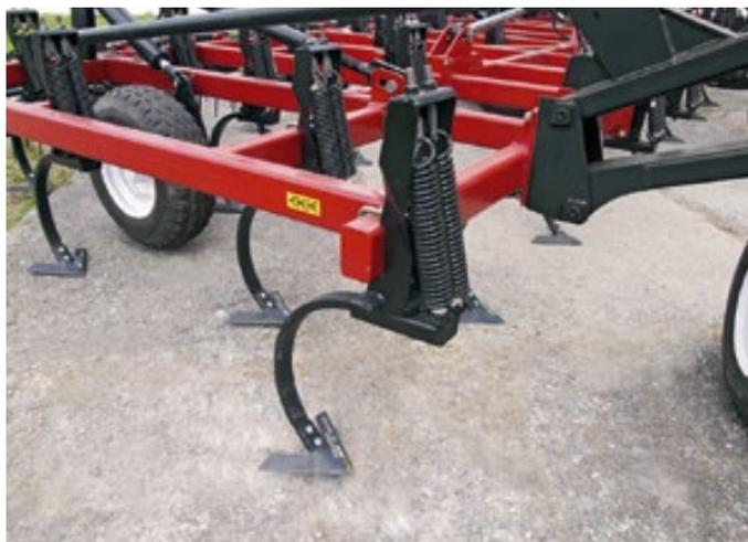
**Мощная и надежная дуговая стойка сошника** – один из главных элементов в процессе перемешивания почвы и пожнивных остатков в поверхностных слоях. Усилие пружин подвески рабочих органов составляет 250 кг и позволяет добиться стабильного хода стрелчатых лап, что особенно важно для предпосевной подготовки почвы.
