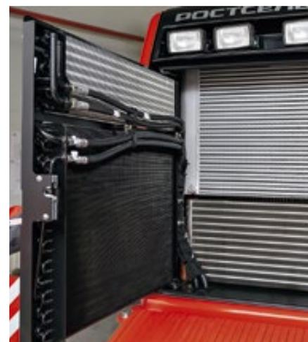
**Передняя решетка радиаторов** легко открывается наружу, подобно створке окна, для удобной очистки, заправки, контроля радиаторов двигателя, трансмиссии, кондиционера, охладителя топлива. Все создано для удобства в работе и экономии времени оператора.
