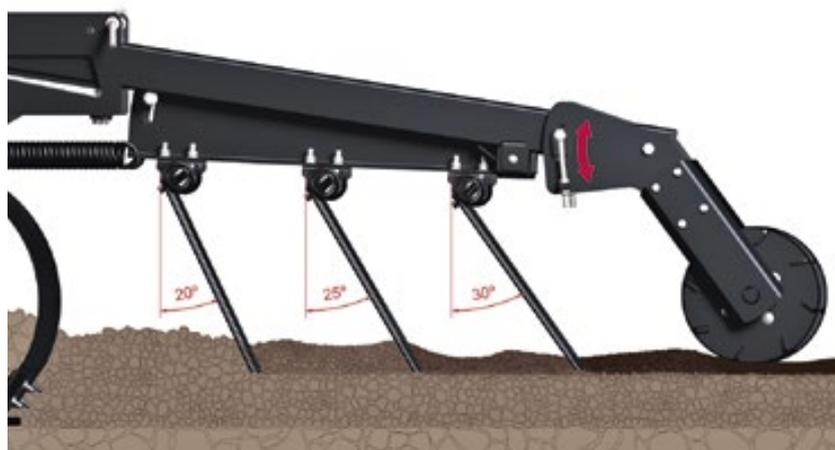
**Трехрядные пружинные бороны** с размером зубьев  $495 \times \varnothing 11$  мм имеют уникальную настройку. Каждый ряд зубьев работает на разных углах атаки – 20°, 25°, 30° – и на разную глубину. Таким образом обеспечивается оптимальное выравнивание поверхности при равномерной нагрузке на зубья.
