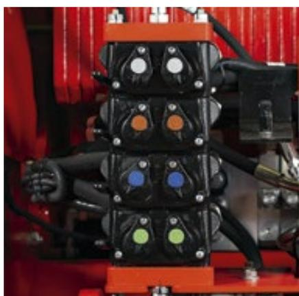
**Четкая маркировка соединительных муфт**, расположенная в задней части трактора, выполнена в соответствии с цветом рычагов контроля, установленных в кабине. Удобное для оператора расположение соединительных муфт позволяет легко подсоединять оборудование. Это значительно сокращает время, необходимое для работы в сжатые временные отрезки в разгар полевых работ.
