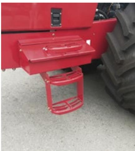
**Поднявшись по удобным ступенькам лестницы**, можно легко осмотреть компоненты двигателя и заливную горловину радиатора. Все механизмы расположены в прямой зоне видимости оператора, что заметно упрощает работу.
