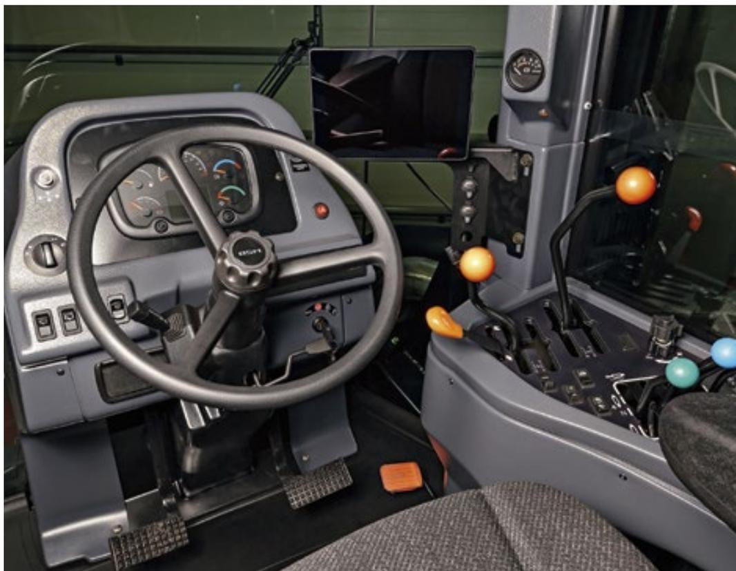
**На боковой стойке кабины** предусмотрено место для крепления GPS-приемника, монитора посевного комплекса и других систем, управляющих прицепным оборудованием.
